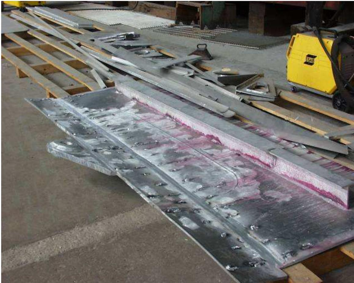
**Figura 18** Inspeção por líquidos penetrantes em painel de alumínio (AA).
