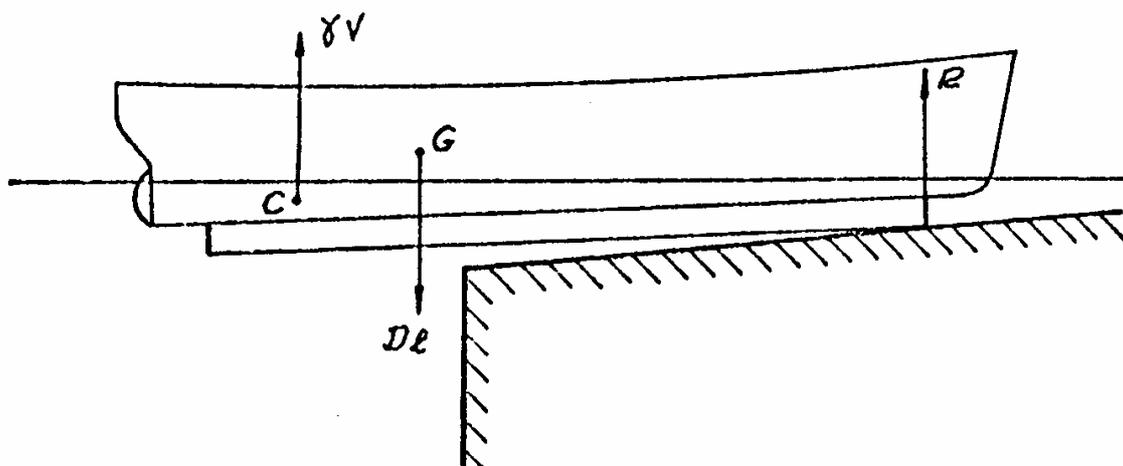
Figura 4 Rotação em torno do berço de vante
