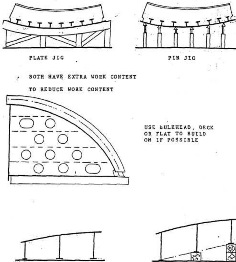
Figura 19 Apoio dos blocos
