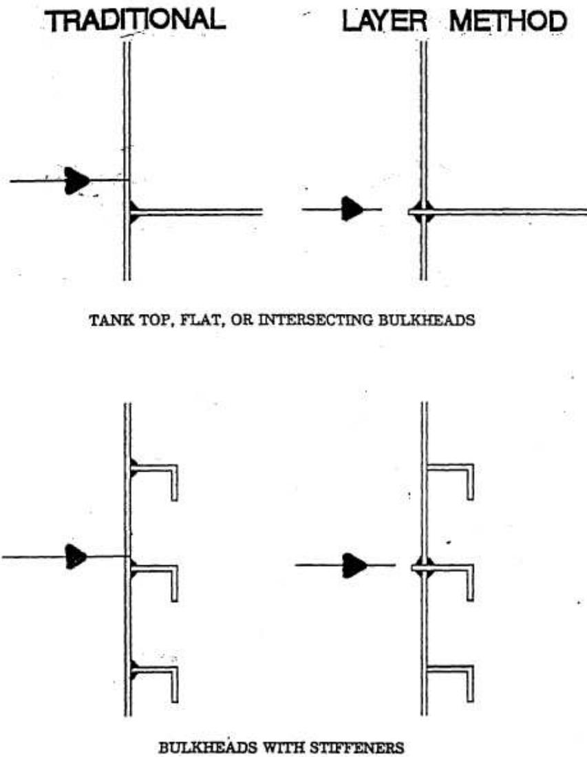
Figura 16 Método de construção em camadas
