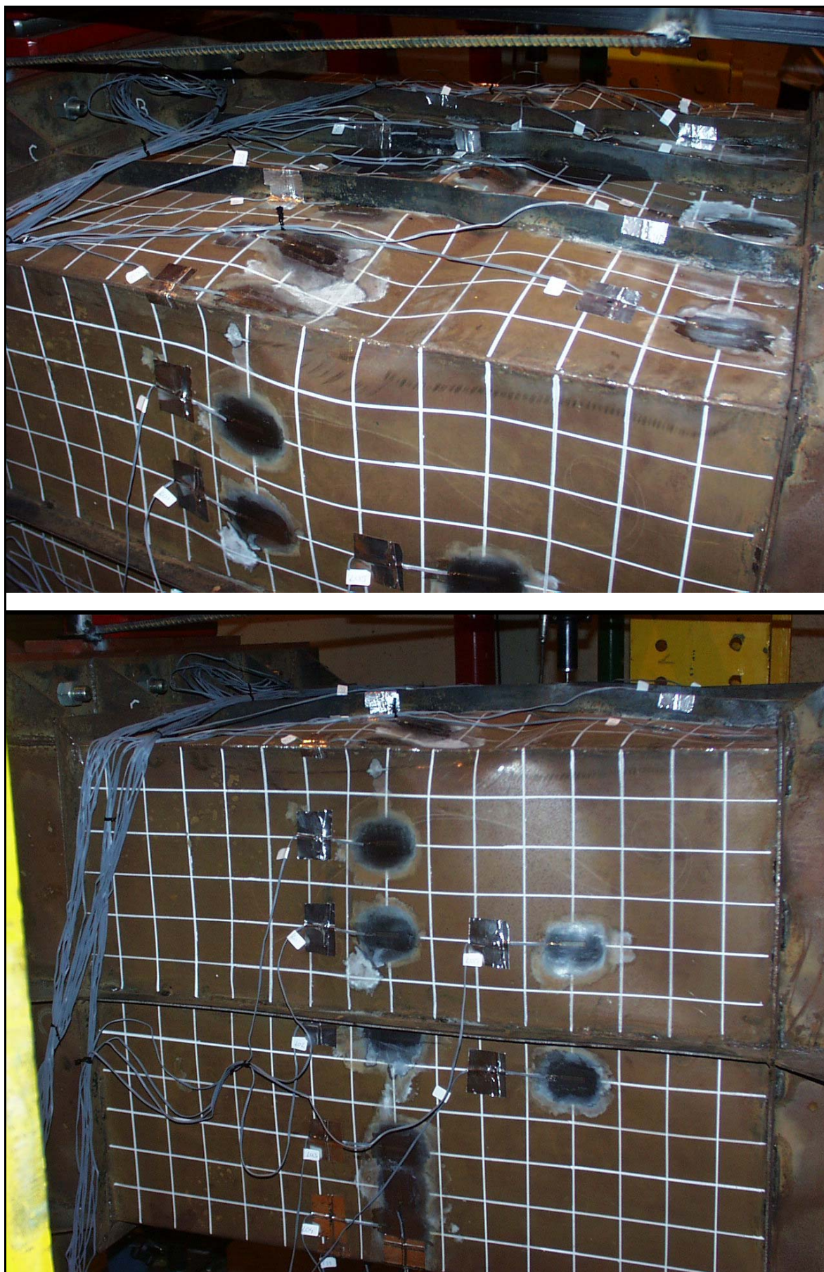
Figura 259 Deformada final residual no painel superior e costado.
