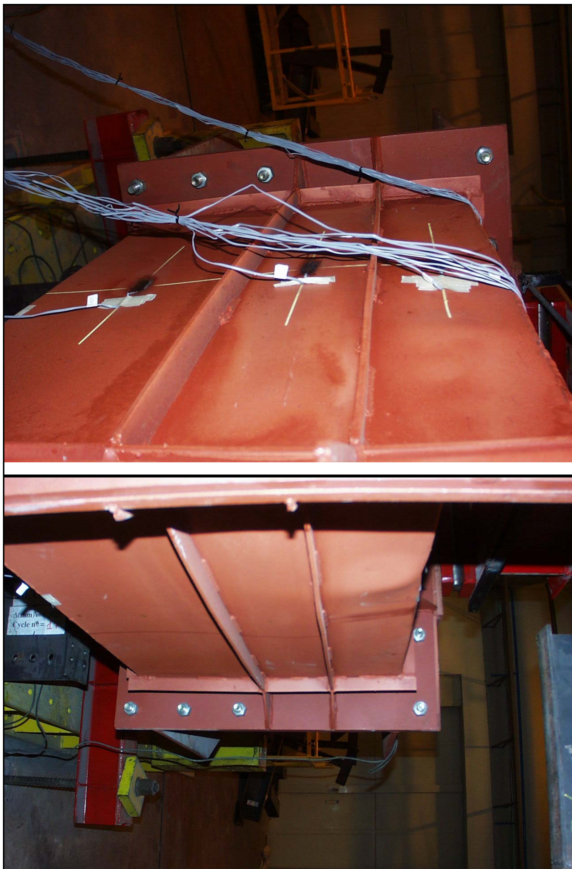
Figura 234 Deformações induzidas nos costados mais acentuadas de um dos lados. Importância do espaçamento dos reforços do costado na limitação do dano.
