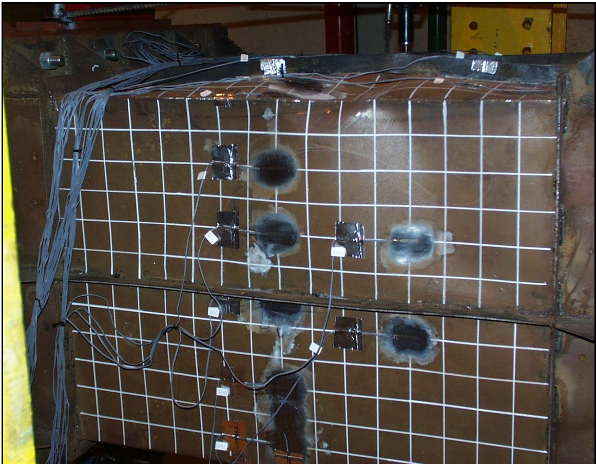
Figura 261 Levantamento do painel em compressão em direcção ao reforço, característico da falha da placa.
