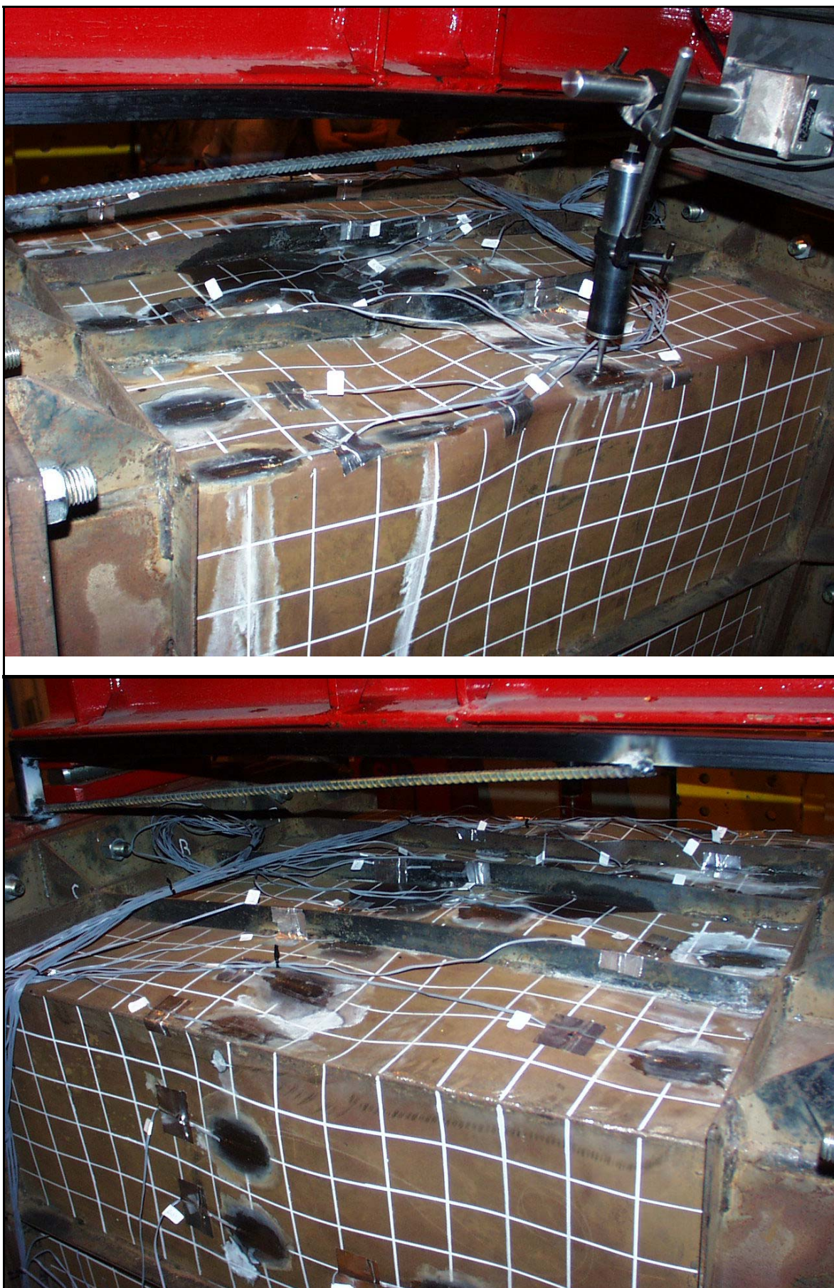
Figura 258 Deformada de colapso vista de lados opostos em fase intermédia.
