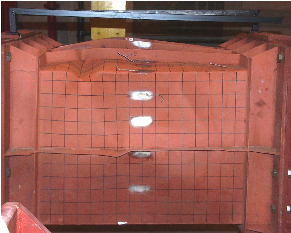
Figura 170 Deformação residual no costado do modelo M3-200 após o colapso total da viga.
