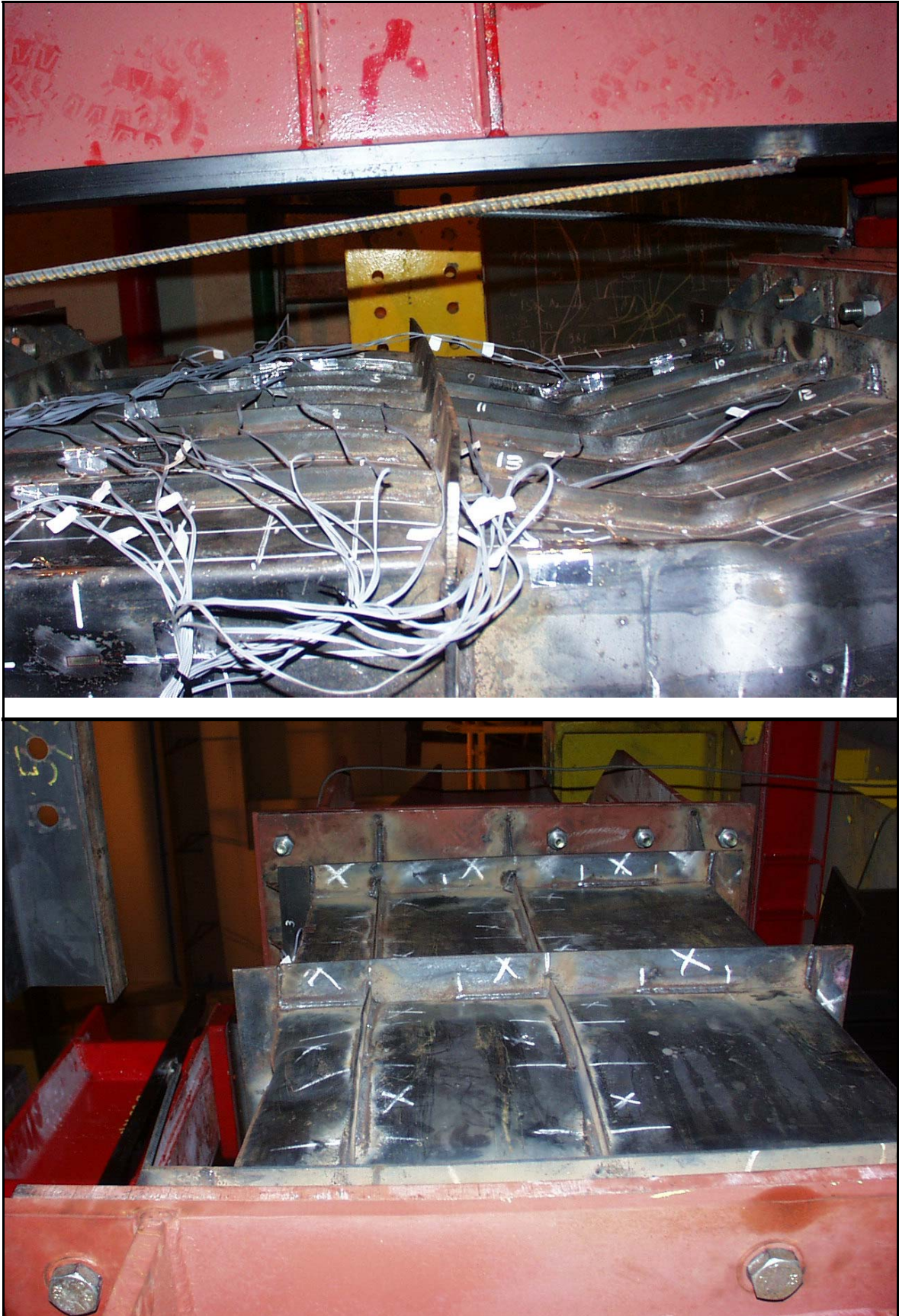
Figura 263 Geometria de colapso do painel em compressão e sua interação com o costado (em cima) e deformada de colapso do costado (em baixo). Notar a natureza local do colapso.
