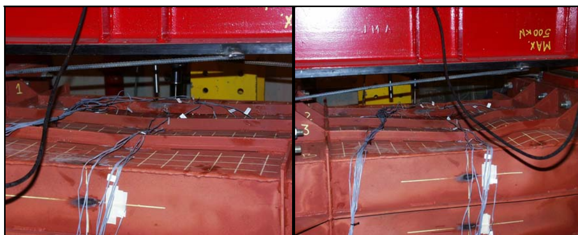
Figura 237 Sequência de colapso. À esquerda, início. À direita, depois de grandes deformações plásticas.
