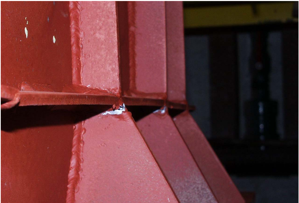
Figura 210 Falha dos esquadros no ensaio do modelo M4-200
