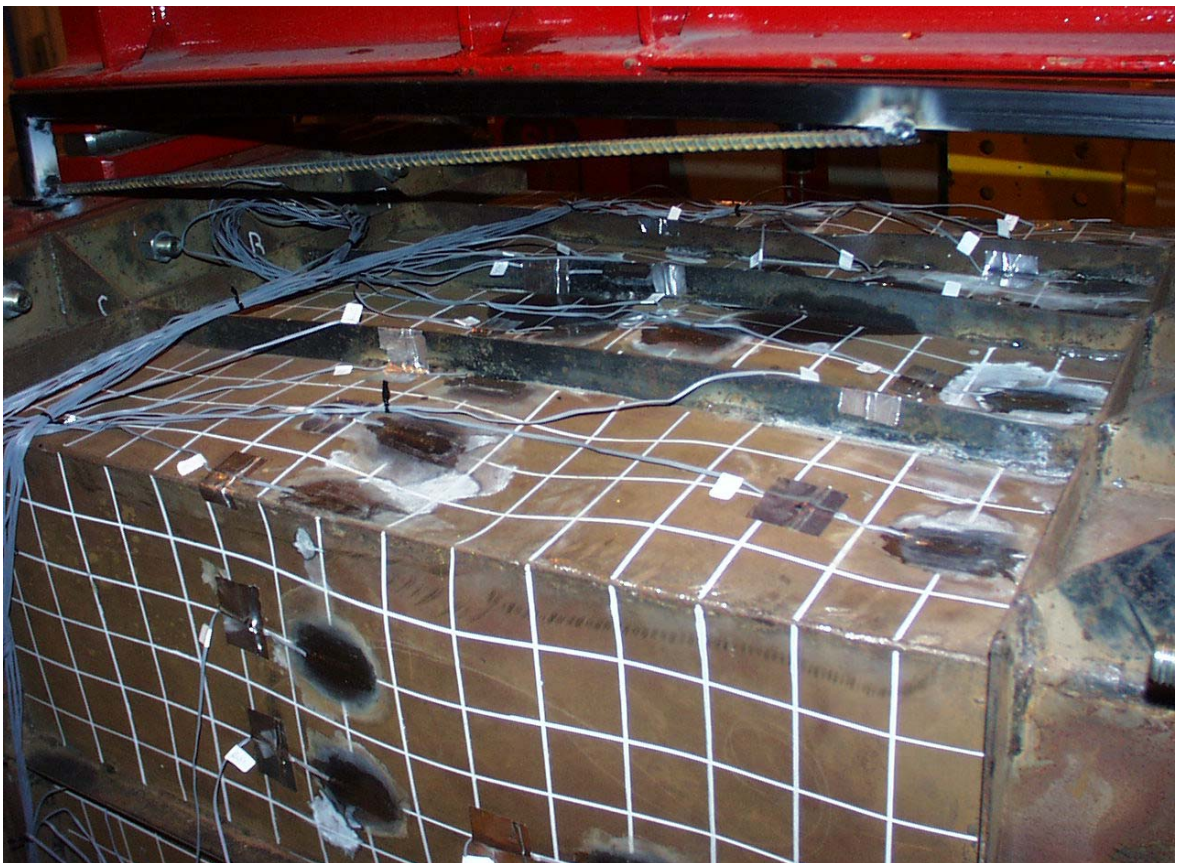
Figura 192 Deformada durante o colapso do modelo M2-200 vista de lados opostos.
