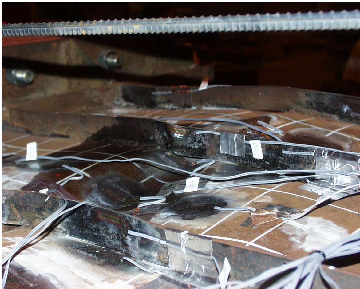
Figura 203 Deformações permanentes no final do ensaio do modelo M2-200.
