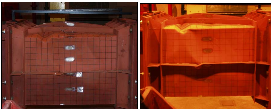
Figura 243 Localidade do colapso e desenvolvimento de deformações permanentes induzidas até ao fundo o qual corresponde ao painel em tracção.
