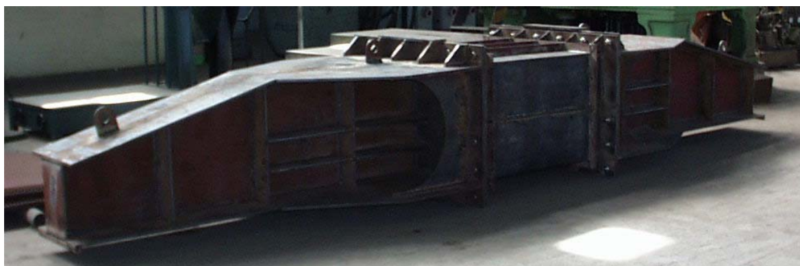
Figura 140 Modelo de viga em caixão montada com respectivos mordentes
