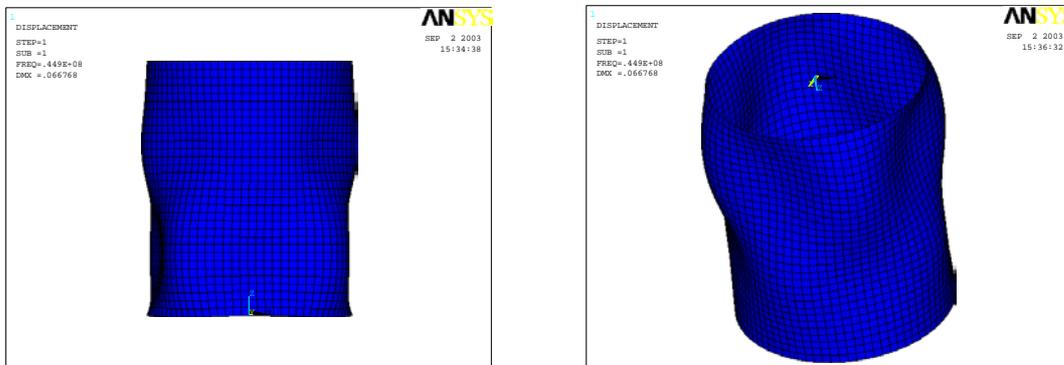
Figura 9 Modo de instabilidade do modelo *pipe5*
