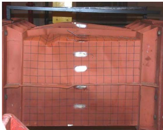
Figura 13 Deformação residual no costado do modelo M3-200 após o colapso total da viga.
